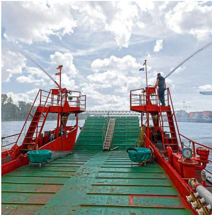
Vier Wasserwerfer gibt es zum Löschen.
